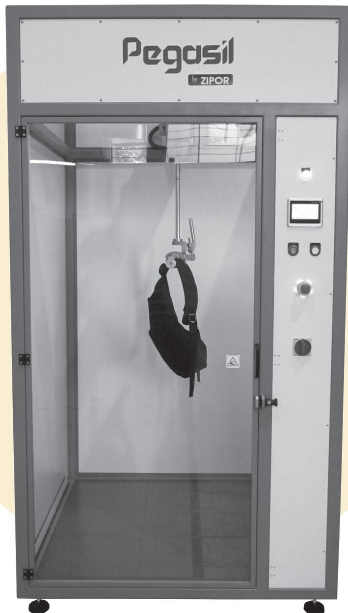
Equipamento desenvolvido de acordo com a norma QB/T2922-2018, com a finalidade de testar a resistência de marroquinaria (malas, bolsas e mochilas) a impactos repetidos (fadiga) e vibração. O conceito é igualmente aplicável a trolleys.
