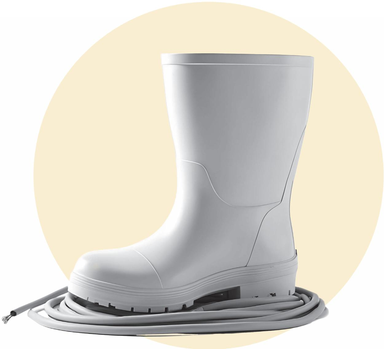
Este equipamento desenvolvido de acordo a norma Europeia EN 50321-1:2018 [Live working - Footwear for electrical protection - Insulating footwear and overboots], visa a avaliação de calçado e galochas (isolantes elétricos), que fornecem proteção aos operadores contra choque elétrico em trabalhos sob tensão até 36.000 V.AC ou 25.000 V.DC.
